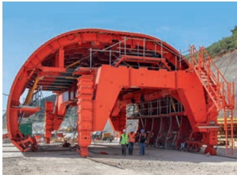
Einsetzbar für Tunnel von ca. 500 m bis über 2.000 m Länge
