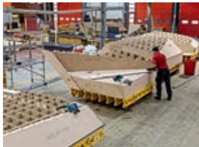
Zur Herstellung von komplexen, vielfach gekrümmten Stahlbetonbauteilen bietet PERI passgenau gefertigte 3D-Volumenkörper.
