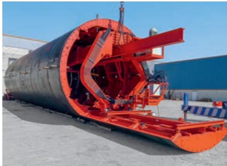
Projektspezifische Schalungslösung, anpassbar an verschiedene Abmessungen und Bauverfahren
