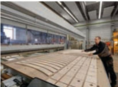
Mit modernsten CNC-Maschinen werden Platten mit höchster Präzision und gemäß den Vorgaben aus der PERI CAD-Plandatei zugeschnitten.
