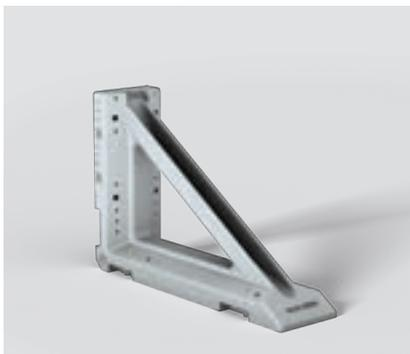
Mit dem PERI Abschalwinkel aus Kunststoff werden Unterzüge bis 60 cm und Deckenrandabschalungen bis 40 cm Höhe geschalt.
