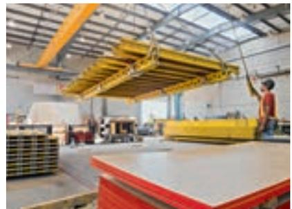
Die Vormontage von Träger-Wandschalungen, 3D-Schalungskörpern oder auch Schwerlast-traggerüsten für den Infrastrukturbereich kann auch am PERI Standort durchgeführt werden.
