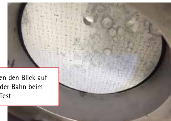
Andere marktübliche Bahn. Nach fünf Jahren natürlicher Alterung, ist die Bahn bereits ohne Druckbeaufschlagung undicht.
