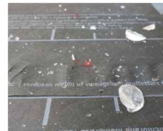
Die pro clima-Bahnen bleiben auch nach mehrfachem Beschuss mit den grösstmöglichen Hagelkörnern unbeschädigt
