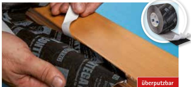
Für den außenseitig winddichten und schlagregensicheren Anschluss von Fenstern und Türen an flankierende Bauteile aus Holz und mineralische Untergründe, wie z. B. Beton und Mauerwerk, vollflächig klebend.
