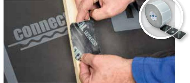
Einseitig klebendes Nageldichtungs-Klebpflaster unter der Konterlattung bei geneigten Dachkonstruktionen. Geeignet als Zubehör für die Erstellung von Behelfdeckungen im Sinne der Produktdatenblätter des ZVDH für Unterdeck- und Unterspannbahnen. 300 Patches pro Rolle.
