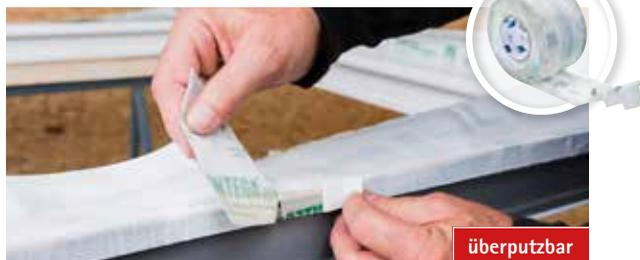
Für den inneren luftdichten Anschluss von Fenstern und Türen an die Dampfbrems- und Luftdichtungsebene. Aufgrund der intelligenten, feuchtevariablen Funktionsmembran ist CONTEGA SOLIDO IQ-D auch für den äußeren winddichten und schlagregensicheren Anschluss geeignet. Die Klebezone auf der Vliesseite ermöglicht einfachere Verklebung an Fenster und Türen bei Verarbeitung vor deren Montage.
