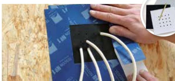
Für die schnelle und dauerhaft dichte Durchführung von bis zu 16 Kabel mit Durchmesser 4,8 bis 12 mm. Jede Manschette als komplettes Set inkl. Schablone und Stanzwerkzeug.
