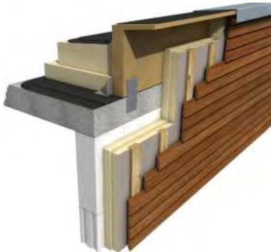
*puren HoltaFix® - Hochleistungsdämmsystem mit integrierter Unterkonstruktion für die einfache und wärmebrückenfreie Herstellung der Hinterlüftungsebene bei vorgehängten Fassaden.*
