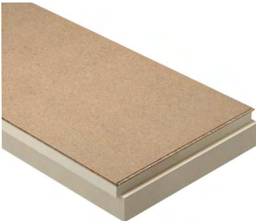
*Die puren DBV Dämmelemente sind mit umlaufendem Stufenfalz versehen und mit einer Holzwerkstoffplatte V100 (N+F) beplankt, das heißt nach der fachgerechten Verlegung der Elemente entstehen keine Wärmebrücken durch Fugen.*
