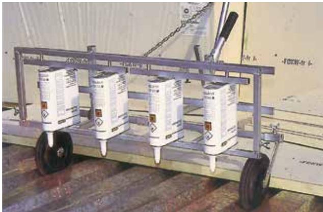
Der puren PUR Dachkleber ist ideal für die Verklebung von Dämmstoffen sowie vlieskaschierten Dachdichtungsbahnen auf verschiedenen Untergründen.
