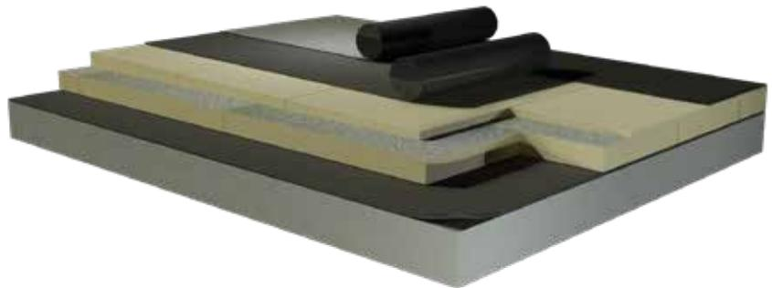
Flachdachaufbau mit aluminiumkaschierter Grunddämmung (puren FD-L) und objektbezogen konfektionierter Gefälledämmung (puren NE-B2), Abdichtung 2-lagig
