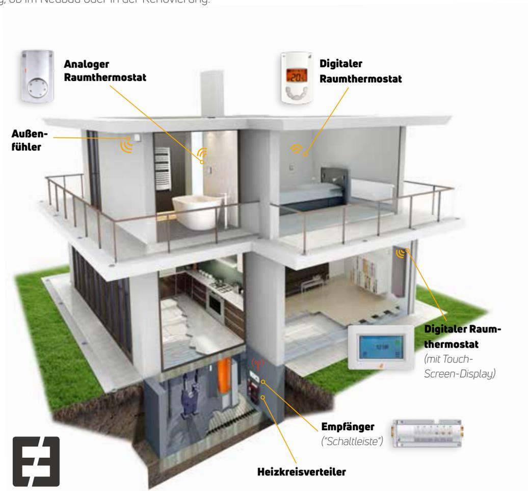
funkbasierten Raumreglern gewählt werden. Die drahtgebundene Regelung eignet sich vor allem für den Neubau und zeichnet sich durch eine hohe Sicherheit vor externen Störeinflüssen aus. Der Regler wird mit dem Steuergerät über ein Kabel verbunden und per Klickmontage auf einer Unterputzeinheit montiert.
