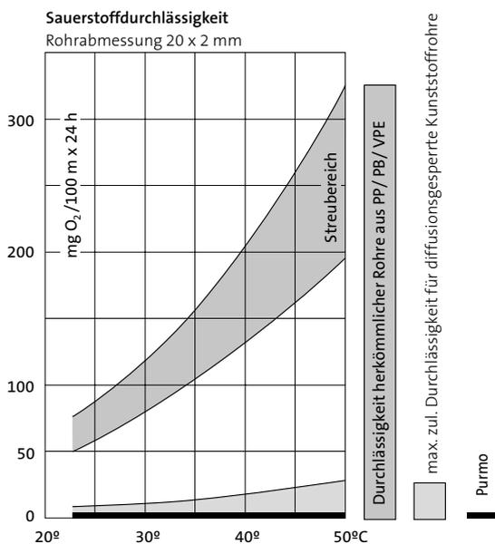
Abb. 1 Sauerstoffdurchlässigkeit Purmo-Heizrohr
