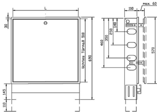
Abb. 96 Maße Heizkreisverteilerschrank Unterputz
