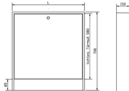
Abb. 97 Maße Heizkreisverteilerschrank Aufputz
