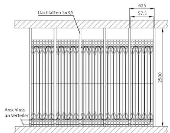
Abb. 68 Schema Trockensystem: Aufsicht
