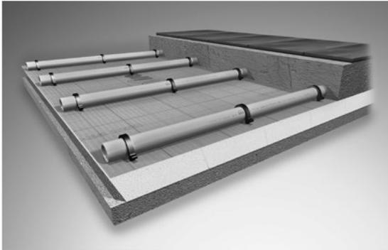
Abb. 69 Systemaufbau Flächenkühlung
