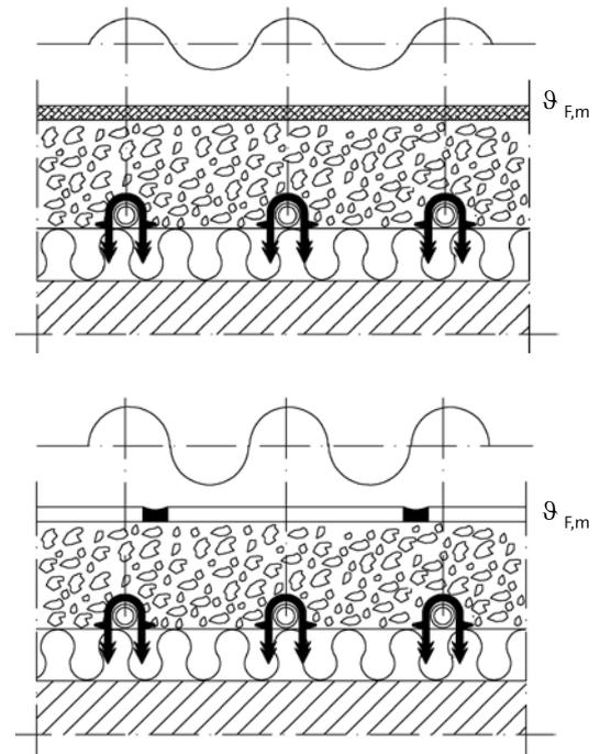
Abb. 132 Temperaturen in der Fußbodenheizung
