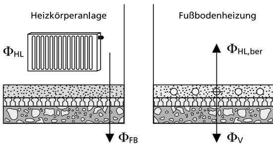
Abb. 133 Wärmeströme durch den Fußboden
