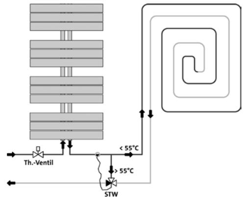
Abb. 104 Funktionsschema der Kombination von Heizkörpern (links der Badheizkörper, an dem direkt das Anschlussblock installiert wird) und Fußbodenheizung (rechts) in einem gemeinsamen Heizungskreislauf mit dem Anschlussblock TempCo VT
