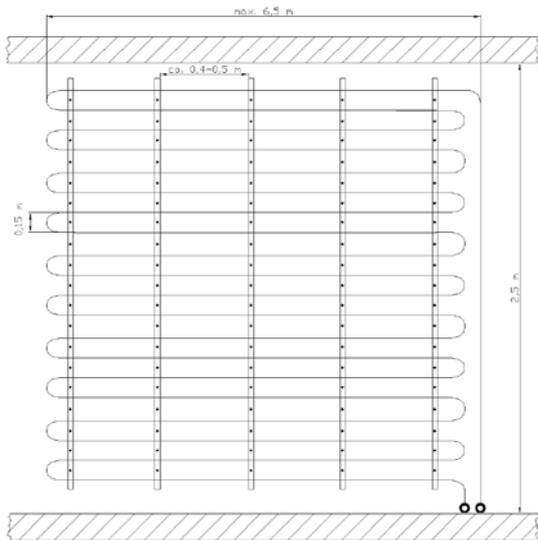
Abb. 66 Schema Wandaufbau Nasssystem
