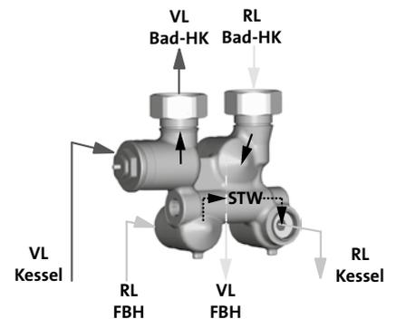
Abb. 105 Prinzipskizze für den Anschluss von TempCo VT (VL= Vorlauf, RL= Rücklauf)
