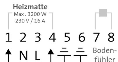
Abb. 84 eljet Anschluss Uhrenthermostat
