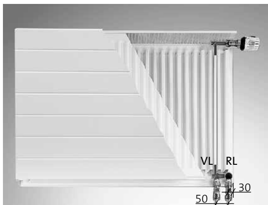
Abb. 76 Integrierte Ventilgarnitur. Schnitt und Funktionsmaße (in mm, VL= Vorlauf, RL= Rücklauf)
