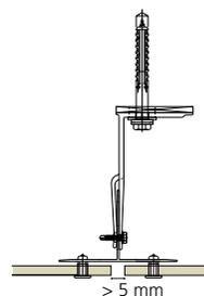
Aluminium-Unterkonstruktion, vertikale Fugenlösung
