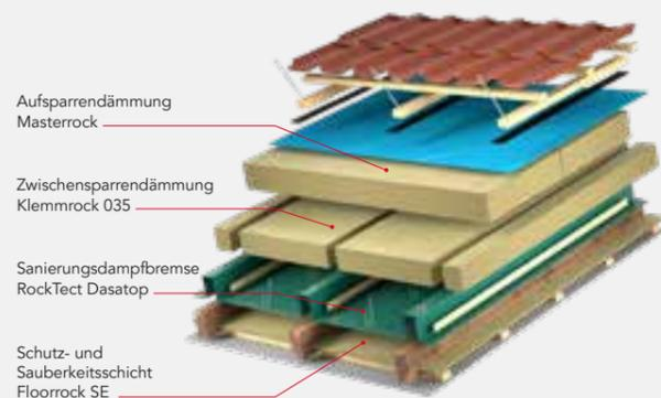
RockTect Dasatop wird schlaufenartig verlegt und sorgt so für eine geringe Aufbauhöhe:
