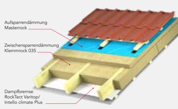
Wenn im Neubau auch eine Zwischensparrendämmung zum Einsatz kommen soll, empfehlen wir, die luftdichte Ebene auf der Innenseite auszuführen (sofort regensicher):
