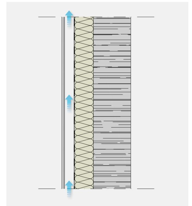
Eine hinterlüftete Fassade führt im Sommer gezielt warme Luft ab und sorgt so für einen sommerlichen Wärmeschutz.
