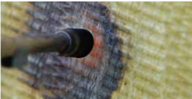
Steinwolle im Brandversuch
