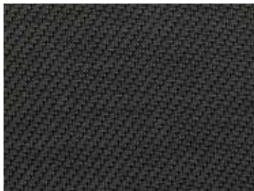
Glasfasergewebe Gewebe aus PVC-ummantelten Glasfasergarnen, Webart Serge
