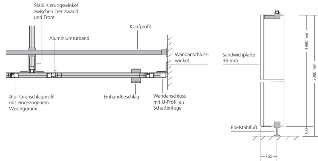
Aufgrund der schwebenden Optik ist eine stabile Befestigung der Wandanschlussteile der Front unbedingt erforderlich. Bitte beachten Sie dazu unsere speziellen technischen Hinweise.
