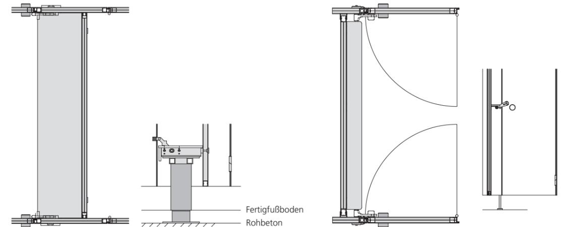
Die EF-3 Wechselkabine kann wahlweise mittels Unterbank-zentralverriegelung oder Hebelzentralverriegelung synchron verriegelt werden.
