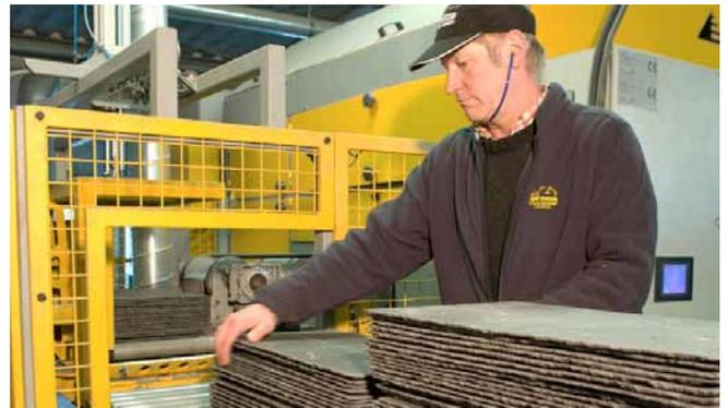
Durchgängige Qualitätskontrollen sichern eine optimale Schieferqualität – unser Schiefer durchläuft in jedem Prozess eine Kontrolle und wird vor Auslieferung einer Klang- und Sichtprobe unterzogen.
