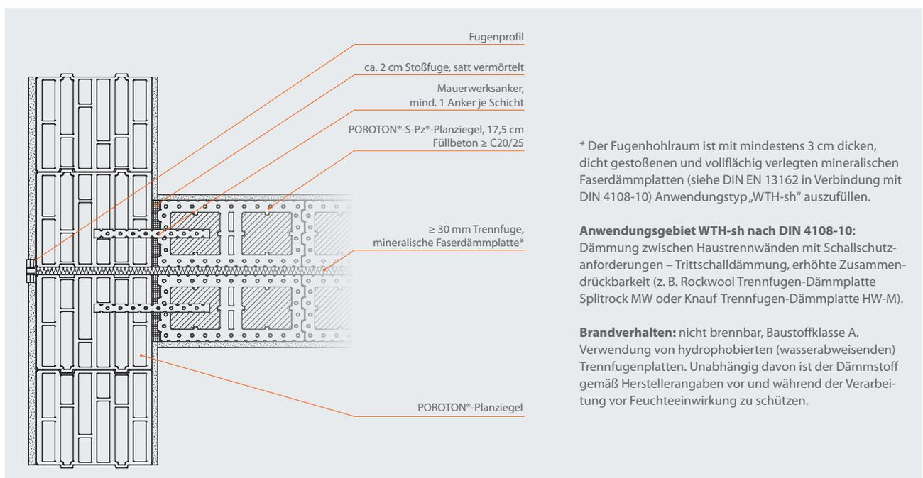
\* Der Fugenhohlraum ist mit mindestens 3 cm dicken, dicht gestoßen und vollflächig verlegten mineralischen Faserdämmplatten (siehe DIN EN 13162 in Verbindung mit DIN 4108-10) Anwendungstyp „WTH-sh“ auszufüllen.
