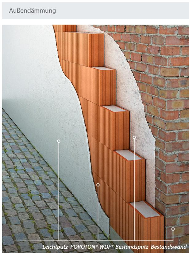
Eine effektive Außendämmung an der Fassade besteht aus genau einer Schicht POROTON®-WDF®, als Endbeschichtung reicht Leichtputz.
