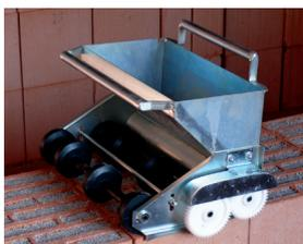
Die **V.D-Mörtelrolle** zur vollflächigen **Deckelung** der Lagerfuge ohne Glasfilamentgewebe.
