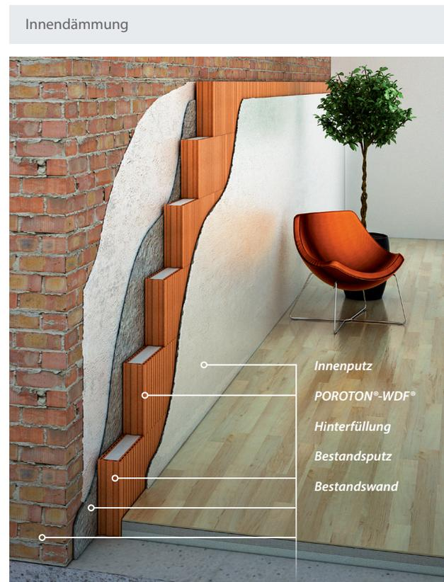
Im Gegensatz zu vielen anderen Dämmsystemen wird die POROTON®-WDF® nicht an die Bestandswand geklebt, sondern freistehend davor aufgemauert. Dadurch werden Probleme durch lose Putzstellen oder Unebenheiten vermieden.
