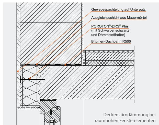
Deckenstirndämmung bei raumhohen Fensterelementen
