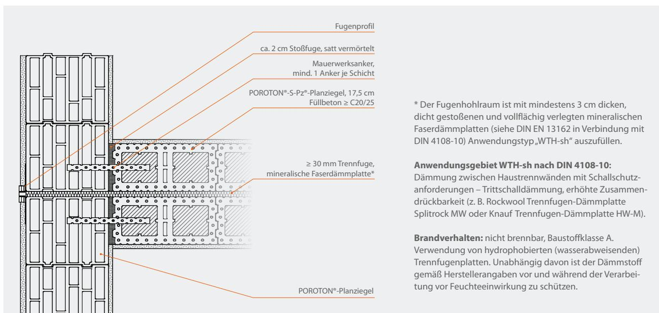
\* Der Fugenhohlraum ist mit mindestens 3 cm dicken, dicht gestoßen und vollflächig verlegten mineralischen Faserdämmplatten (siehe DIN EN 13162 in Verbindung mit DIN 4108-10) Anwendungstyp „WTH-sh“ auszufüllen.
