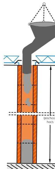
Geschosshohes Verfüllen mit fließfähigem Beton:
