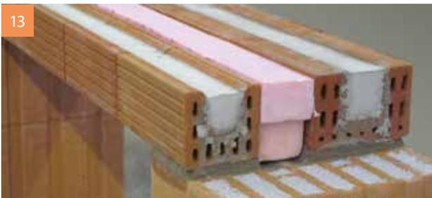
13 Ausbildung von Fenster- und Türstürzen mit Einlegen einer Wärmedämmung WLG 035,  $d \geq 7,0$  cm, Sturzhöhe 11,3 cm.
