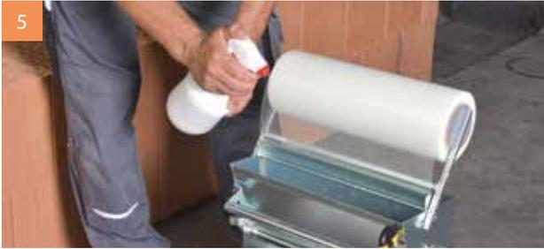
5 Die V.Plus®-Walze vor dem Befüllen mit Trennmittel (Schalöl) einsprühen. Das erleichtert die spätere Reinigung.
