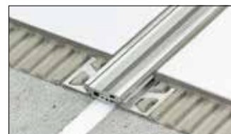
Schlüter-DILEX-BT ist ein Bautrennfugenprofil aus Aluminium mit seitlicher Gelenkanbindung des ineinander verschiebbaren Mittelteils. Somit ist eine dreidimensionale Bewegungsaufnahme möglich. (Produktdatenblatt 4.20)
