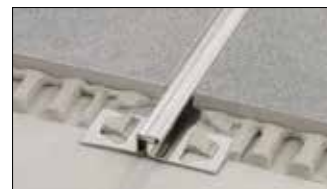
Schlüter-DILEX-EDP ist ein Bewegungsprofil aus Edelstahl, welches durch eine Nut- und Federverbindung horizontale Bewegungen aufnehmen kann. (Produktdatenblatt 4.16)
