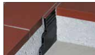
Schlüter-DILEX-MP ist ein Dehnungsfugenprofil mit hinterschnittenen Seitenwänden aus Hart-PVC-Regenerat und einer die Seitenwände überdeckenden Dehnzone aus Weich-Kunststoff mit Verlängerungsprofilen für den Einbau bei Mörtelverlegung. (Produktdatenblatt 4.3)
