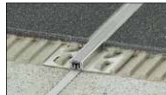
Schlüter-DILEX-KS ist ein Bewegungsprofil mit Kantenschutz, bestehend aus seitlichen Befestigungsschenkeln aus Aluminium oder Edelstahl, die mit einer auswechselbaren Dehnzone aus weichem Kunststoff verbunden sind. (Produktdatenblatt 4.8)
