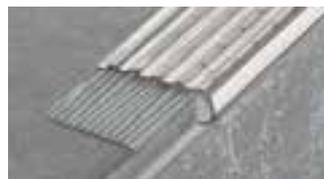
Schlüter-TREP-EK ist ein Treppenprofil aus Edelstahl mit spezieller rutschhemmender Profilierung zur sicheren und optisch ansprechenden Ausgestaltung von Stufenkanten. Es lässt sich nachträglich auf Stufen aus Fliesen oder Natursteinplatten aufkleben.
