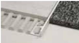
Schlüter-SCHIENE ist ein spezielles Profil zum Abschluss der Außenkanten an Fliesenbelägen, lässt sich aber auch für andere Belagsmaterialien und Anwendungen sehr gut einsetzen. Durch den Fugensteg wird eine definierte Fugenkammer zur Fliese vorgegeben. Schlüter-SCHIENE-E hat keinen Fugensteg.
