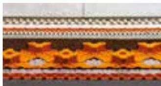
Schlüter-BEKOTEC-DRAIN ist die sichere, besonders dünn-schichtige Belagskonstruktionstechnik als System für rissfreie und funktionssichere schwimmende Estriche im Außenbereich mit Belägen aus Keramik und Naturstein.
