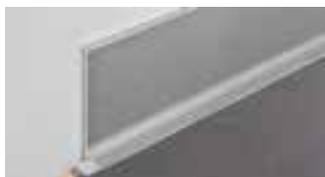
Schlüter-DESIGNBASE-SL ist ein hochwertiges Profil zur Erstellung von Sockelbekleidungen in den Höhen von 60 bis 160 mm. Es schützt den Sockelbereich sowie die Randfuge vor Verschmutzungen. Die optionale Dichtlippe verhindert das Eindringen von Feuchtigkeit.
