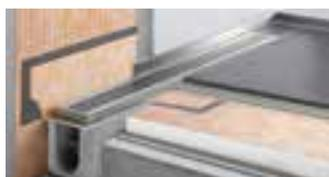
Schlüter-KERDI-LINE-H / -V / -F sind komplette Sets für lineare bodenebene Duschen mit einem horizontalen/vertikalen Ablauf. Sie sind universell für den zentralen Einbau in einer Fläche oder im Wandbereich einsetzbar. Auf dem umlaufenden Klebeflansch des Rinnenkörpers ist werkseitig eine Manschette aus Schlüter-KERDI fest verklebt. Sie dient zum sicheren Anschluss des Rinnenkörpers an die Verbundabdichtung sowohl im Bodenbereich als auch an aufgehenden Wänden. (Produktdatenblatt 8.7)
