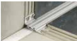
Schlüter-DILEX-BTO ist ein Bautrennfugenprofil aus Aluminium für Boden-/Wandübergänge. Durch die seitliche Gelenkanbindung des ineinander verschiebbaren Mittelteils ist eine dreidimensionale Bewegungsaufnahme möglich. (Produktdatenblatt 4.20)
