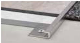
Schlüter-VINPRO-S ist ein spezielles Abschlussprofil aus eloxiertem Aluminium zum Einfassen elastischer Beläge (z. B. LVT-Böden). Das Profil kann als Kantenschutz für elastische Bodenbeläge, Teppichböden bzw. ähnlich dünnen Belägen Abschlusskante oder als Wandabschlüsse genutzt werden.
