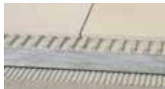
Schlüter-DITRA-SOUND ist eine Schwerfolie auf Polyethylenbasis, die vorder- und rückseitig mit einem Vlies zur Verankerung im Fliesenkleber versehen ist. DITRA-SOUND dient in Verbindung mit Fliesenbelägen als Verbund-Trittschalldämmung. (Produktdatenblatt 6.3)
