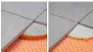
Schlüter-TROBA-STELZ-MR sind Kunststoffringe, die als Verlegehilfe für großformatige Plattenelemente auf Balkonen und Terrassen dienen. Die 25 mm hohen Kunststoffringe werden an den Fugenkreuzungspunkten der Plattenelemente mit Mörtel ausgefüllt, worauf dann die Plattenelemente verlegt werden. Schlüter-TROBA-STELZ-DR sind Schalungsringe für Dünnbettmörtel auf Schlüter-TROBA-PLUS 8G.
