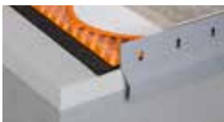
Schlüter-BARA-RKL ist ein winkelförmiges Randprofil mit Entwässerungslöchern aus farbig beschichtetem Aluminium. Es eignet sich für großformatige Plattenelemente, die wahlweise auf ungebundene Kies-/ Splittschüttungen oder auf Stelzlager verlegt werden. Speziell für 2 cm dicke, selbsttragende Keramikelemente und Natursteinplatten stehen Profile in den Höhen 35 bzw. 40 mm zur Verfügung. (Produktdatenblatt 5.20)
