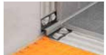
Schlüter-DILEX-RF ist ein zweiteiliges Profil aus Hart- / Weich-Kunststoff mit einer Nut- und Federbindung für dauerhaft flexible und wartungsfreie Randfugen als Boden-Wand bzw. Sockelanschluss.
