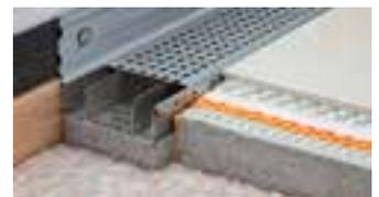
Schlüter-TROBA-LINE-TL ist eine Drainagerinne aus Edelstahl, die bei niedrigen Anschlusshöhen zu Türelementen auf Balkonen und Terrassen eingebaut werden kann, um aufstauendes Wasser zu verhindern. Ebenso kann sie als Flächendrainagerinne verwendet werden.
