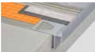
Schlüter-BARA-RAKEG ist ein Randprofil mit Tropfkante zur Verlegung auf einen fertigen Gefälleestrich. Es ist für den Konstruktionsaufbau mit der Verbundentkopplung Schlüter-DITRA 25 ausgelegt. Durch die geschlossene Aufkantung erhält man einen sauberen Fliesenabschluss. (Produktdatenblatt 5.22)
