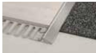
Schlüter-RENO-U ist ein Profil zum stufenlosen Übergang verschieden hoher Bodenbeläge. Durch den Fugensteg wird eine definierte Fugenkammer zur Fliese vorgegeben. Schlüter-RENO-EU, -EBU und -MU haben keinen Fugensteg.
