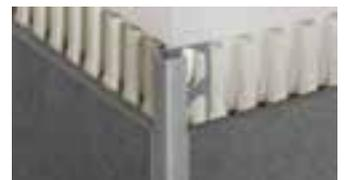
Schlüter-QUADEC ist ein hochwertiges Abschlussprofil aus Edelstahl, farblich beschichtetem/strukturbeschichtetem Aluminium, eloxiertem Aluminium, verchromtem Messing oder farbigem PVC für Wandaußenecken und Abschlüsse von Fliesenbelägen und bietet einen guten Kantenschutz. Die Sichtfläche des Profils bildet eine rechtwinklige Außenecke der Fliesenbeläge.
