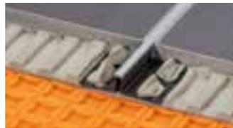
Schlüter-DILEX-BWS ist ein Bewegungsfugenprofil mit Seitenteilen aus Hart-PVC-Regenerat. Die Bewegungszone besteht aus weichem Kunststoff und bildet die 5 mm breite Sichtfläche.
