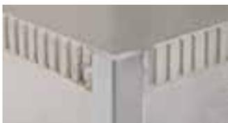
Schlüter-ECK-E ist ein Edelstahl-Eckprofil für Wandaußenecken an Fliesenbelägen und bietet einen stabilen Kantenschutz. Die gelochten Befestigungsschenkel werden bei der Fliesenverlegung in den Fliesenkleber eingebettet.
