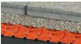
Schlüter-TROBA ist eine Trenn- und Drainageschicht über horizontalen Abdichtungen unter Estrich- oder Kiesauflagen. Sie besteht aus einer druckstabilen Polyethylen-Noppenfolie mit Löchern zu den Drainagekanälen. Zur Fliesenverlegung auf Estrichschichten muss als Entkopplung und Abdichtung Schlüter-DITRA 25 eingebaut werden.
