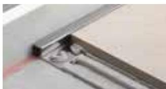
Schlüter-DILEX-KSA ist ein Anschlussprofil mit Kantenschutz, bestehend aus einem seitlichen Befestigungsschenkel aus Aluminium oder Edelstahl, der mit einer auswechselbaren Dehnzone aus weichem Kunststoff verbunden ist. Es dient zum Anschluss von Belagsflächen an feste Einbauteile wie z. B. Fensterelemente. (Produktdatenblatt 4.8)
