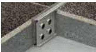
Schlüter-DILEX-EMP ist ein Bewegungsprofil aus Edelstahl für die Mörtelbettverlegung, welches durch eine Nut- / Federverbindung horizontale Bewegungen aufnehmen kann. (Produktdatenblatt 4.17)
