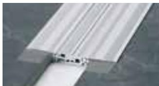
Schlüter-DILEX-BTS ist ein Bautrennfugenprofil aus Aluminium für den nachträglichen Einbau in fertige Belagsflächen. Durch die seitliche Gelenkanbindung des ineinander verschiebbaren Mittelteils ist eine dreidimensionale Bewegungsaufnahme möglich. (Produktdatenblatt 4.20)
