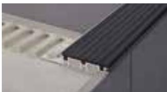
Schlüter-TREP-S/-S-E/-B sind Treppenprofile aus Aluminium oder Edelstahl (TREP-S-E) mit einer eingeklemmten auswechselbaren Auftrittsfläche aus rutschhemmendem Kunststoff. Sie sind wahlweise mit breiter (TREP-B) oder schmalere (TREP-S und -S-E) Auftrittsfläche erhältlich.
