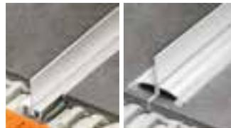
Schlüter-SHOWERPROFILE-WS /-WSK sind zweiteilige Profile aus eloxiertem Aluminium für den Schwallschutz in bodenebenen Duschanlagen. Das Trägerprofil zu SHOWERPROFILE-WSK wird nachträglich auf vorhandene Beläge aufgeklebt. Das Trägerprofil zu SHOWERPROFILE-WS wird im Zuge der Fliesenverlegung im Kleberbett verankert. Beide Varianten sind für das Befahren mit Rollstühlen geeignet.
