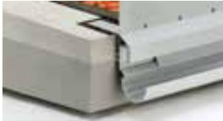
Schlüter-BARA-RKLT ist ein winkelförmiges Randprofil mit Entwässerungslöchern aus farbig beschichtetem Aluminium. Es eignet sich für großformatige Plattenelemente, die wahlweise auf ungebundene Kies-/ Splittschüttungen oder auf Stelzlager verlegt werden. BARA-RKLT besitzt eine T-förmige Profilkammer zur Befestigung des Rinnensystems Schlüter-BARIN.
