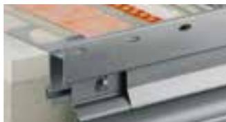
Schlüter-BARA-RTKE ist ein Randprofil mit Tropfkante zur Verlegung auf einen fertigen Gefälleestrich. Das Profil hat eine Aufnahmevorrichtung zur Befestigung des Rinnensystems Schlüter-BARIN. Das Profil BARA-RTKE ist besonders gut für den Konstruktionsaufbau mit der Verbunddrainage Schlüter-DITRA-DRAIN geeignet. Durch die gelochte Aufkantung erhält man einen sauberen Fliesenabschluss. (Produktdatenblatt 5.21)
