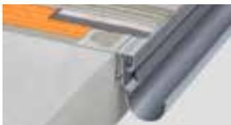
Schlüter-BARA-RTK ist ein Randprofil mit Tropfkante zur Verlegung auf einen fertigen Gefälleestrich. Das Profil hat eine Aufnahmevorrichtung zur Befestigung des Rinnensystems Schlüter-BARIN. Die Fliesen können mit Überstand verlegt werden. Alternativ kann auf dem vertieften Übergang zur Tropfkante ein Schlüter-JOLLY als Abschluss der Fliesenkante aufgebracht werden. (Produktdatenblatt 5.9)
