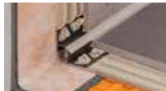
Schlüter-DILEX-EK ist ein zweiteiliges Profil aus Hart-/Weich-Kunststoff mit einer Nut- und Federbindung und integrierter Fliesenkammer. Es dient zur Herstellung dauerhaft flexibler und wartungsfreier Randfugen als Boden-/Wand- bzw. Sockelanschluss.
