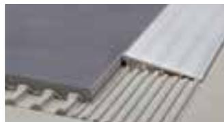
Schlüter-RENO-RAMP-K ist ein Profil für den stufenlosen Übergang von stark belasteten Fliesenbelägen zu einem angrenzenden niedrigen Belagsmaterial. Das Profil kann zum nachträglichen Höhenausgleich zwischen Belagsmaterial und Untergrund verklebt werden.
