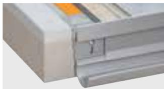
Schlüter-BARA-RTKEG ist ein Randprofil mit Tropfkante zur Verlegung auf einen fertigen Gefälleestrich. Das Profil hat eine Aufnahmevorrichtung zur Befestigung des Rinnensystems Schlüter-BARIN. Es ist für den Konstruktionsaufbau mit der Verbundentkopplung Schlüter-DITRA ausgelegt. Durch die geschlossene Aufkantung erhält man einen sauberen Fliesenabschluss. (Produktdatenblatt 5.21)
