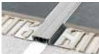
Schlüter-DILEX-KSBT ist ein Bautrennfugenprofil mit Kantenschutz, bestehend aus seitlichen Befestigungsschenkeln aus Aluminium oder Edelstahl, die mit einer 20 oder 30 mm breiten Bewegungszone aus weichem Kunststoff verbunden sind. (Produktdatenblatt 4.19)
