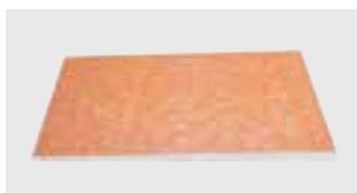
Schlüter-KERDI-SHOWER-LT / -LTS sind Gefälleboards aus druckstabilem Polystyrol mit einer werkseitig aufkaschierten Schlüter-KERDI Abdichtung. In bodengleichen Duschen stellen sie ein ausreichendes Gefälle zur Linienentwässerung Schlüter-KERDI-LINE her. Individuelle Abmessungen lassen sich anhand vorgegebener Schneidnuten einfach mit dem Cuttermesser zuschneiden. (Produktdatenblatt 8.8)
