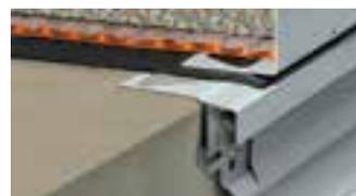
Schlüter-BARA-RWL ist ein Randprofil mit Entwässerungslöchern aus beschichtetem Aluminium für den Randbereich von Balkonen und Terrassen. Es eignet sich besonders für den Abschluss von Balkon- und Terrassenbelägen, die lose auf Kies oder Stelzlager verlegt werden. (Produktdatenblatt 5.15)
