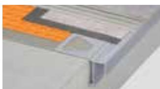
Schlüter-BARA-RAK ist ein Balkon-Randprofil mit Tropfkante aus farbig beschichtetem Aluminium. Es wird im Randbereich auf einer fertigen Gefällefläche verlegt und dient dort als Randabschluss und Tropfkante. (Produktdatenblatt 5.5)
