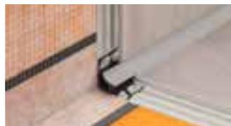
Schlüter-DILEX-HK ist ein Hohlkehprofil aus hartem PVC-Regenerat mit einer Hohlkehle aus Weich-Kunststoff und integrierter Fliesenkammer für den Wand-/Bodenanschluss. Das Profil erfüllt besondere Anforderungen an Hygiene und Reinigungsmöglichkeiten, wie sie zum Beispiel in der Lebensmittelindustrie oder in Großküchen bestehen.
