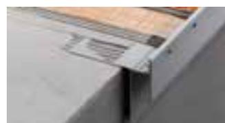
Schlüter-BARA-RAKE ist ein Randprofil mit Tropfkante zur Verlegung auf einen fertigen Gefälleestrich. Das Profil BARA-RAKE ist besonders gut für den Konstruktionsaufbau mit der Verbunddrainage Schlüter-DITRA-DRAIN geeignet. Durch die gelochte Aufkantung erhält man einen sauberen Fliesenabschluss. (Produktdatenblatt 5.22)
