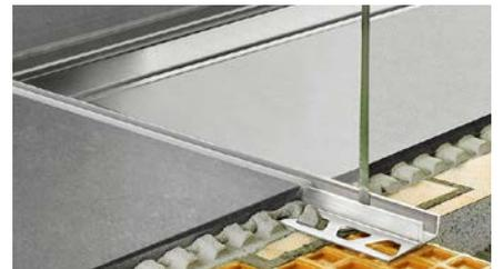
Schlüter-SHOWERPROFILE-WS ist ein zweiteiliges Profil für den sicheren Schwallenschutz in bodenebenen Duschen. Das Trägerprofil aus eloxiertem Aluminium wird bei der Fliesenverlegung im Kleberbett verankert und kann mit einer halbrunden oder einer aufrechten geraden Dichtlippe versehen werden.
