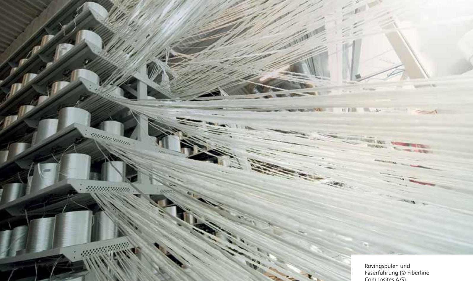
Rovingspulen und Faserführung (© Fiberline Composites A/S)
