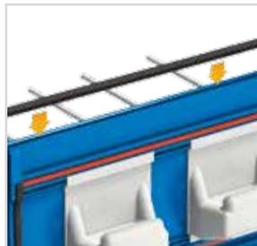
Einfacher Einbau durch mitgelieferte Nagelleisten zur direkten Befestigung an die Schalung.
