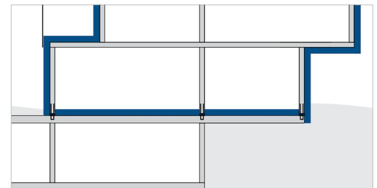
Stark reduzierter Materialaufwand durch die Verlegung der Dämmebene auf die Geschossdecke
