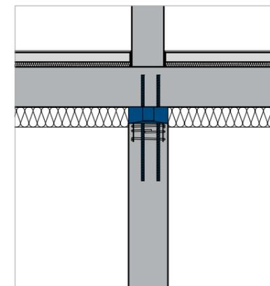
Anwendung am Stützenkopf für Unterdecken-dämmung.
