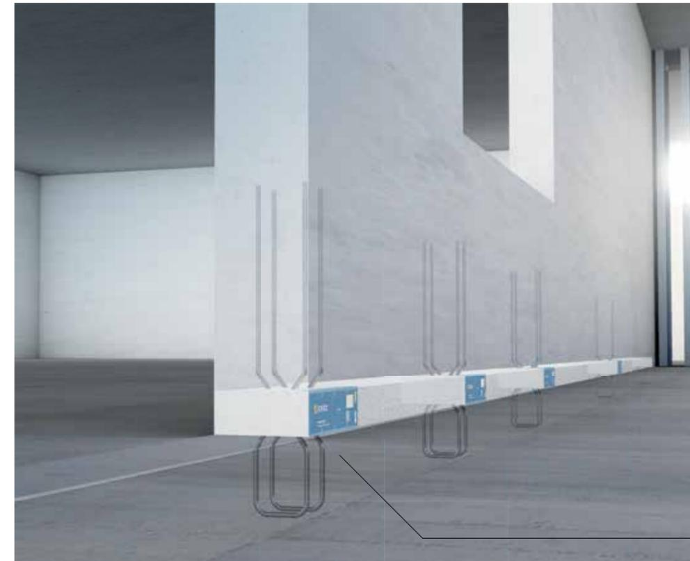
Durch den gelenkigen Anschluss können unerwünschte Kräfte aus Rotation im Anschlusspunkt vermieden werden. Die negativ wirkende Interaktion zwischen Druckkraft und Biegemoment entfällt. Dies vereinfacht die Nachweiseführung und führt zu einer sicheren Bemessung.
