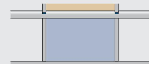
Aufdeckendämmung Tiefgarage / Keller
