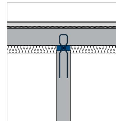
Anwendung am Wandkopf bei Unterdecken-dämmung.
