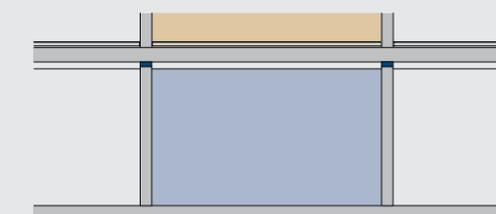
Unterdeckendämmung Tiefgarage / Keller
