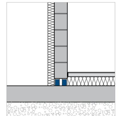
Anwendung bei Dämmung am Mauerfuß auf Bodenplatte.
