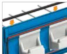
Einfacher Einbau durch mitgelieferte Nagelleisten zur direkten Befestigung an die Schalung.
