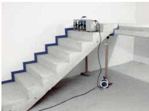
Realitätsnaher Prüfaufbau nach DIN 7396
