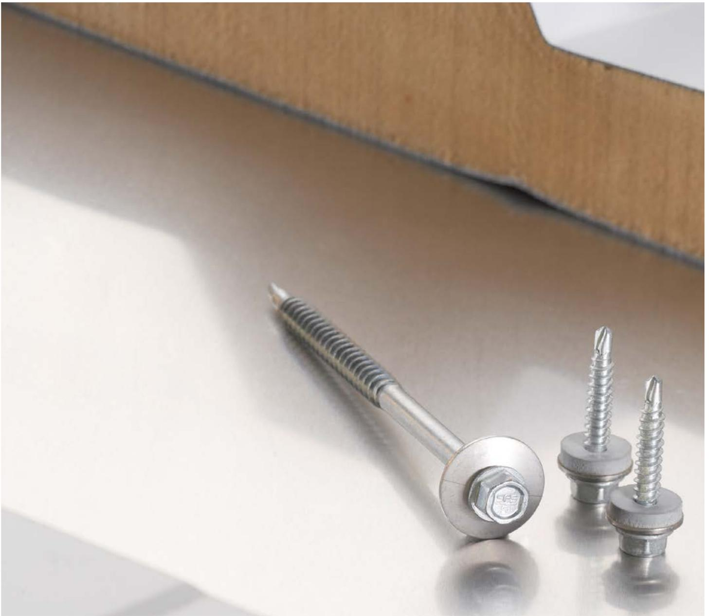
**Befestigung von Sandwichelemente in einem Arbeitsgang: Die SXC-Bohrbefestiger von SFS sind speziell für die hohen Anforderungen bei Sandwich-Systemen entwickelt worden. Dynamische Belastungen durch Temperatureinwirkungen, Begehen oder Windlasten haben keine negativen Auswirkungen auf die Funktionalität der Befestigungen. Stützgewinde, gewindefreie Zone und die abgestimmte Dichtscheibe ergeben eine dauerhaft dichte Verbindung.**
