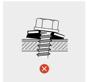
Die Verwendung eines Tiefenanschlages wird empfohlen.
