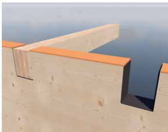
Mass-X ® Entkopplungsprofil unter Balken zur Schallsisolierung.
