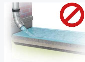
**Ohne SitaAttika Kaskade** besteht das Risiko der Überflutung tiefer liegender Flächen sowie statische Überlastung. Unfallgefahr droht durch über den Plattenbelag verlegte Abflussrohre.
