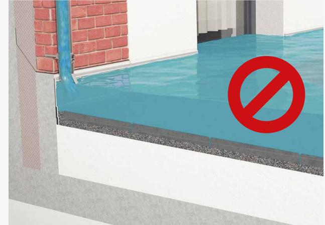
**Ohne SitaKaskade** besteht das Risiko der Überflutung tiefer liegender Flächen sowie statische Überlastung. Unfallgefahr droht durch über den Plattenbelag verlegte Abflussrohre.
