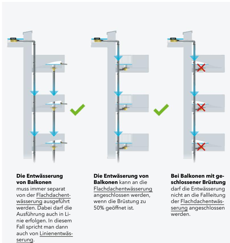
**+ Zusatzwissen:** Bei Balkonen und Dachterrassen mit einer geschlossenen Brüstung ist die Notentwässerung laut DIN 18531-5, Pkt. 6.3 so anzuordnen und zu dimensionieren, dass im Fall des Versagens der Hauptentwässerung die Türschwelle nicht überstaut werden kann - insbesondere bei reduzierten Anschlusshöhen an Türen. Bei Anschlusshöhen < 5 cm ist gemäß der SitaRichtlinie Pkt 3.5 der komplette Jahrhundertregen  $r_{(5,100)}$  über die Notentwässerung abzuführen.
