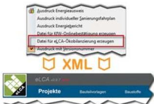
Transfer von Projektdaten an Ökobilanzierungs-Tool eLCA mittels xml-Datei nach GEG für ein NWG
