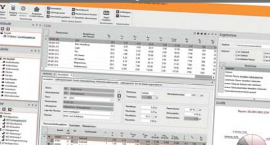
**Modular aufgebautes Paket zum Planen von Heizungsanlagen aller Art. Heizlast nach DIN EN 12831-1, dynamisch nach VDI 6020 sowie zur TW-Erwärmung nach DIN EN 12831-3. Berechnen von Heizkörpern, Flächenheizungen und kombinierten Systemen. Heizungs-Rohrnetzrechnung inkl. Schema-Editor. Verarbeiten neutraler und/oder fabrikatbezogener TGA-Objektdaten. Schnittstellen zum Integrieren in CAD oder BIM-Arbeitsprozesse.**
