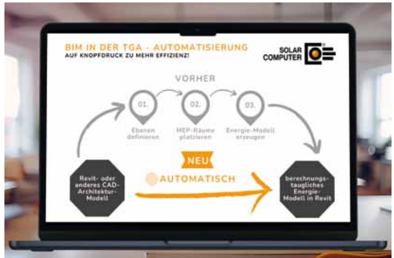
Das neue Revit Plug-in GBIS schafft effiziente Workflows in der TGA: zeitintensive Umsetzungsschritte wurden automatisiert, sodass aus einem Revit oder IFC-Architekturmodell ein berechnungstaugliches Energiemodell erzeugt wird.
