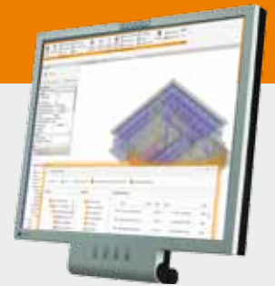
Das neue Revit Plug-in GBIS schafft effiziente Workflows in der TGA: zeitintensive Umsetzungsschritte wurden automatisiert, sodass aus einem Revit oder IFC-Architekturmodell ein berechnungstaugliches Energiemodell erzeugt wird.
