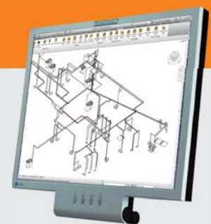
Steuerung des Berechnungsablaufs (u. a. Auslegung, hydraulischer Abgleich) aus der Revit-Oberfläche. Integration relevanter Berechnungs-Daten/-Ergebnisse als GBIS-Eigenschaften in Revit.
