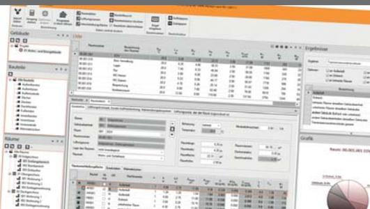
**Modular aufgebautes Paket zum Planen von Heizungsanlagen aller Art. Heizlastberechnung für Gebäude nach DIN EN 12831 Teil 1, Berechnung der Warmwasserbereitung nach Teil 3. Berechnen von Heizkörpern, Flächenheizungen und kombinierten Systemen. Heizungs-Rohrnetzberechnung inkl. Schema-Editor. Verarbeiten von neutralen und/oder fabrikatbezogenen TGA-Objektdaten. Schnittstellen zum Integrieren in CAD oder in BIM-Arbeitsprozesse.**
