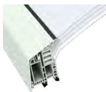
Lichtkuppel essertop® 4-schalig U_g -Wert 1,5 W/m²K U_f -Wert 1,3 W/m²K
