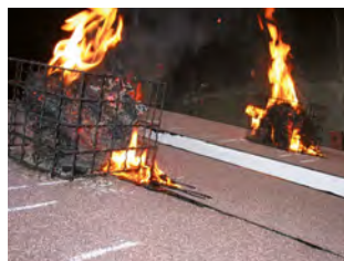
Typischer Dachaufbau mit Bitumenbahnen und Brandversuch
