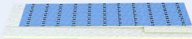
Zweilagiger Aufbau mit bis zu 4 Systemplatten und 100 mm Stufendämmung nach der 4. Gefälleplatte, mit vollflächiger Unterlegung; Variante mit höherem Anteil an Flachplatten
