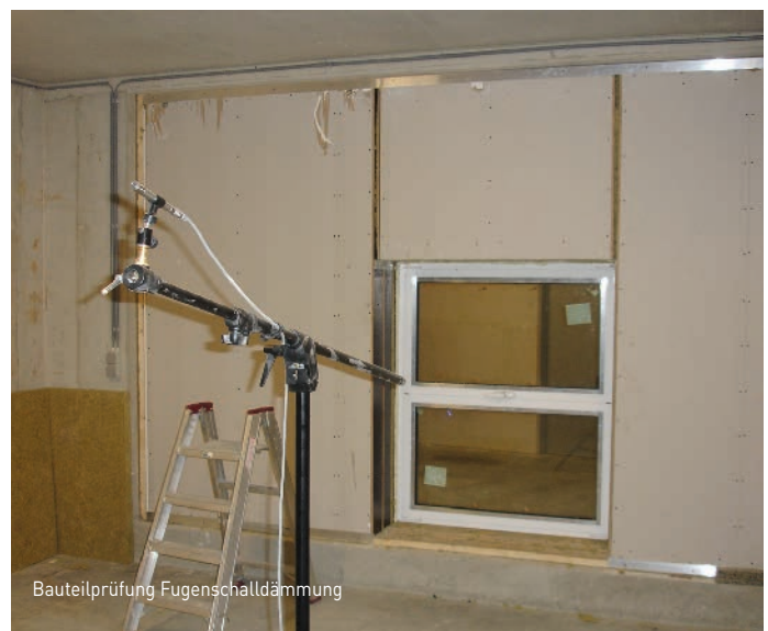
Bauteilprüfung gemäß ift-Richtlinie MO-01/1 Prüfstand mit Sensoren
