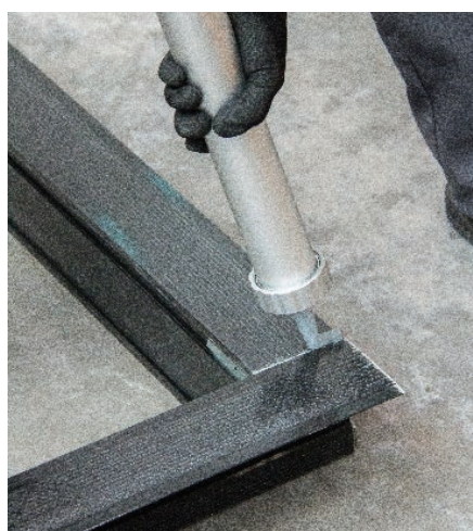
07 Klebstoff auf alle Verbindungen aufbringen
