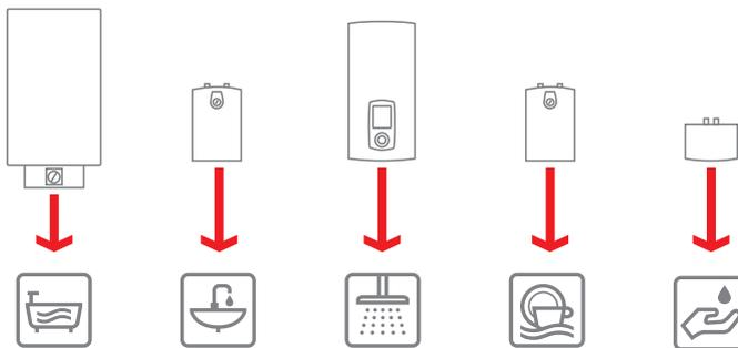
Jede einzelne Zapfstelle erhält eine eigene Warmwasserbereitung. Die Leitungsverluste sind dadurch nur minimal.
