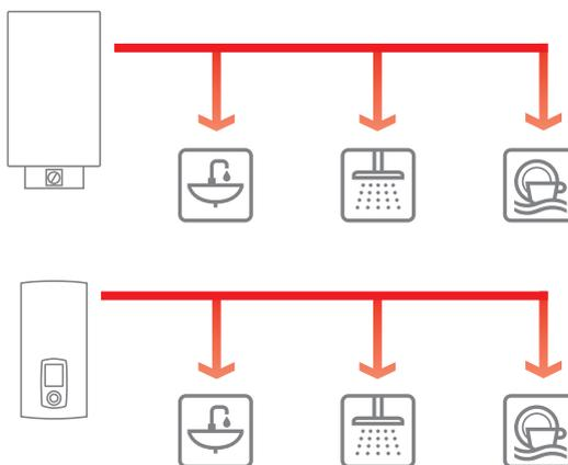
Mehrere nah beieinanderliegende Zapfstellen werden durch ein gemeinsames Warmwassergerät bedient. Leitungsverluste sind größer als bei der Einzelversorgung, aber immer noch gering.
