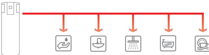
Zur wirtschaftlichen Erzeugung großer Warmwassermengen: Alle Zapfstellen werden durch eine Warmwasserquelle (bspw. Standspeicher oder Warmwasser-Wärmepumpe) versorgt.
