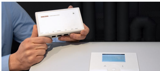
Das ISG wird an die Wärmepumpe und den hauseigenen Internetrouter angeschlossen.
