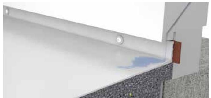
Optimale Einbausituation einer Sto-Fensterbank bei einem Fensterrahmen mit verdeckter Entwässerung
