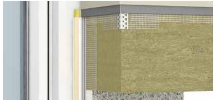
Sto-Anputzleiste Bravo S ist im eingebauten Zustand fast unsichtbar, sichtbar bleibt eine optisch ansprechende Schattenfuge.
