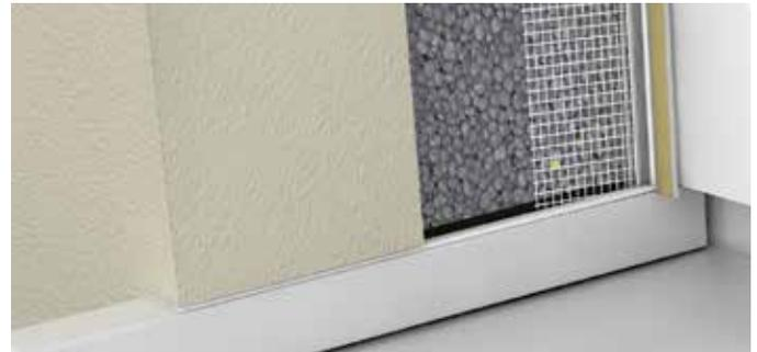
Das Sto-Rillenband ist UV- und witterungsbeständig und bietet eine optisch ansprechende und dauerhafte Trennung zwischen Putz und StoFentra Gleitabschluss.
