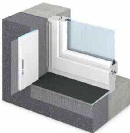
Für die Herstellung der Schlagregendichtheit stehen zwei Fensteranschlussprofile zur Auswahl. Sto-Anschlussprofil Pronto für Fenstergrößen  $\leq 2 \text{ m}^2$  und Dämmstoffdicken  $\leq 200 \text{ mm}$ . Bei größeren Fenstern und Dämmstoffdicken kommt das Sto-Anschlussprofil Pronto 3D mit integriertem Fugendichtband zum Einsatz. Das Anschlussprofil kann Bewegungen in alle Richtungen aufnehmen und bietet dadurch die höchste Sicherheit.
