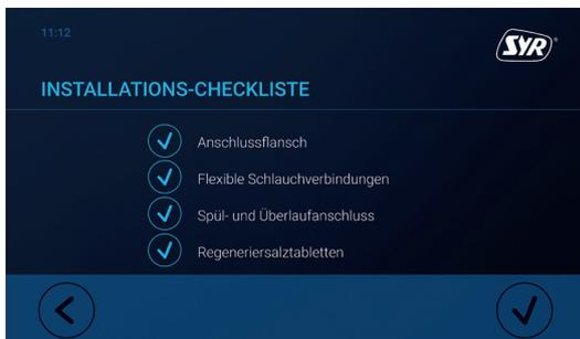
**Einfache, menügeführte Inbetriebnahme.** Ist die NeoSoft Connect installiert, führt der moderne 7" Touchscreen Schritt für Schritt durch die Inbetriebnahme. Zunächst wird mit dem Härtemessbesteck im Deckel die Rohwasserhärte gemessen. Danach geben Sie die gewünschte Weichwasserhärte ein. Die Verschneidung der NeoSoft stellt sich automatisch auf den eingegebenen Wert ein. Ändert sich die Rohwasserhärte, weist die NeoSoft Connect mit einem Warnhinweis darauf hin.
