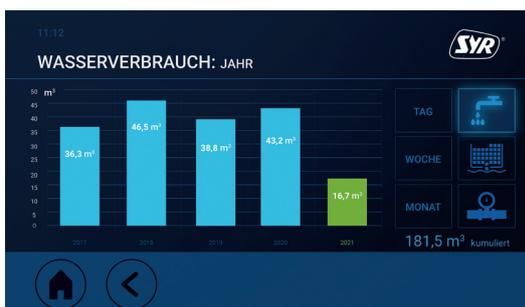
Statistiken wie Wasserverbrauch, ein Logbuch, Wartungseinstellungen und -durchführung – die NeoSoft Connect ist via Touchscreen und im Online-Modus mit der SYR App über Tablet und Smartphone bedienbar und führt Sie mit übersichtlichen Anzeigen durch jeden Vorgang.
