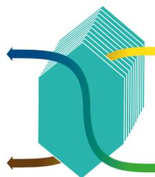
Ein Gegenstromwärmeübertrager dient zur Übertragung von Wärme.
