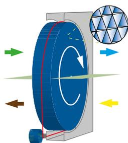
Ein Rotationswärmeübertrager sorgt sowohl für Wärme- als auch Feuchterückgewinnung.
