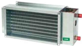
Wasserheizregister für Kanalanschluss mit feuerverzinktem Gehäuse und einem Heizelement aus Kupferrohren und Aluminiumlamellen. Bei kälteren Klimabedingungen sollte ein Frostschutz mit Frostschutzfühler eingebaut werden, um die Gefahr durch Frostschäden zu vermeiden. Das VBR Heizregister ist zur Montage in horizontalen Kanälen geeignet.
