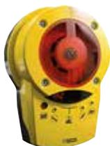
Der Kanalrauchmelder KRM wurde zur Rauchdetektion in Lüftungskanälen entwickelt. Er stellt die Kombination eines Rauchmelders mit einem Adaptersystem dar, dessen Messrohr und Gehäuse speziell für einen optimalen Luftstrom durch den Rauchmelder angepasst wurden. Soll der KRM auf runde oder isolierte Kanalsysteme installiert werden, wird eine Kosole (Artikel-Nr.: 35939 – KRM-O Konsole für Kanalrauchmelder) benötigt. Sehen Sie hierzu das entsprechende Kapitel in der Bedienungsanleitung.
