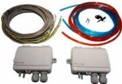
Das VAV-Set (druckkonstant) ist erforderlich um die Kompaktlüftungsgeräte Topvex auf VAV-Regelung umzurüsten. Das Set besteht aus zwei Drucksensoren, Druckschläuche, Verbindungskabel (4 m) und einer Kurzanleitung. Über die Bedieneinheit muss die Regelung gemäß Beschreibung in der Kurzanleitung umgestellt werden.
