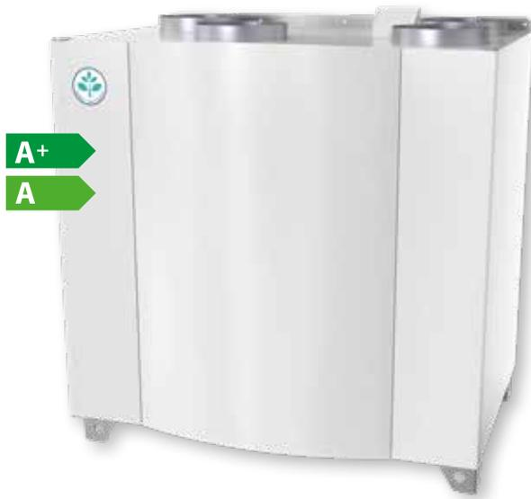
Wohnungslüftungsgerät mit hocheffizientem Gegenstromwärmeübertrager und intelligenter SAVE control Regelung. Integriert ist ein Außenluft-/Zuluftbypass, geräuscharme und energiesenkende RadiCal-Ventilatoren mit bedarfsgesteuerter Drehzahlregelung. Das Gehäuse besteht aus verzinktem Stahlblech (weiß lackiert). Als Zubehör ist ein integrierbares elektrisches Nachheizregister erhältlich.
