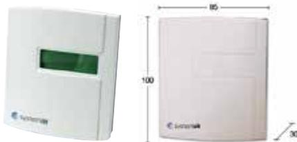
LED-Anzeige zur Anzeige der gemessenen Werte. Messsystem mit CO<sub>2</sub>-Fühler Die CO<sub>2</sub>-Konzentration wird mit Hilfe eines Infrarotlichts gemessen. Mit dieser Technik wird die Absorption der Gase gemessen. Das Messen des CO<sub>2</sub>-Level ergibt eine direkte Angabe der Luftqualität. Mit diesen Angaben kann der Ventilator präziser die Luftqualität verbessern.
