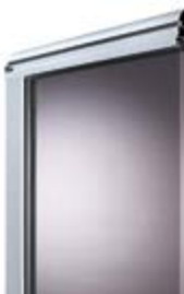
Rahmenprofil mit 20-mm-KS-Doppel- scheibe – grau getönt; Lichtdurchlass: ca. 43 %
