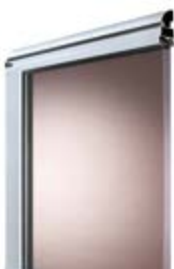
Rahmenprofil mit 20-mm-KS-Doppel- scheibe – braun getönt; Lichtdurchlass: ca. 50 %
