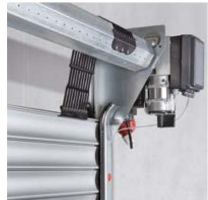
Langlebiges und hochfestes Anbindungssystem zwischen Welle und Torpanzer (Teckentrup Schutzrecht). Die 8-Kant-Wickelwelle inkl. der Zapfen ist vollständig verzinkt.
