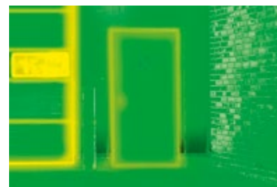
Deutlich geringerer Energieverlust dank thermisch getrennter Tür
