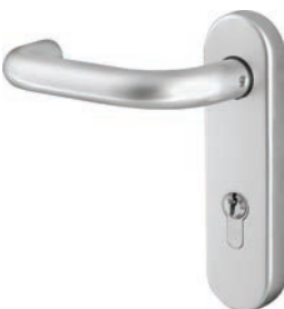
Sicherheits-Drücker-garnitur Klasse ES 1 nach DIN 18257, Aluminium
