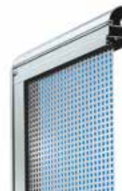
Aluminium-Lochblech, freier Lüftungsquerschnitt: ca. 44 %
