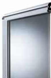
Rahmenprofil mit 19-mm-KS-Doppelscheibe – grün getönt; Lichtdurchlass: ca. 70 %
