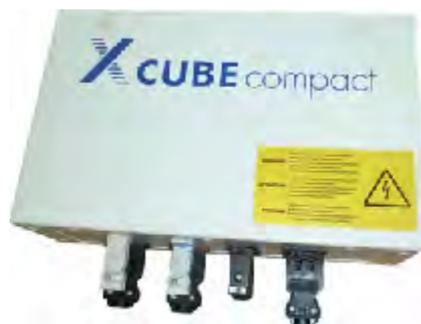
MSR-Modul zur Anbindung von Funktionsmodulen
