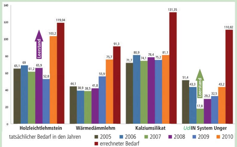
Quelle: Grafik 25 Entwicklung des Heizwärmebedarfs kWh/m<sup>2</sup> der Dämmvarianten von 2005 bis 2010 im Vergleich zu dem errechneten Jahresbedarf (Deutsches Fachwerkzentrum Quedlinburg)
