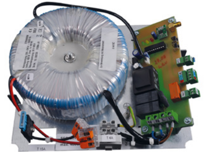
UP-Netzteil für Aufputzgehäuse
