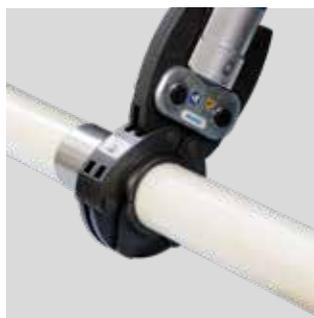
Basispressbacke in die Pressschlinge einhaken und Verpressung auslösen.
