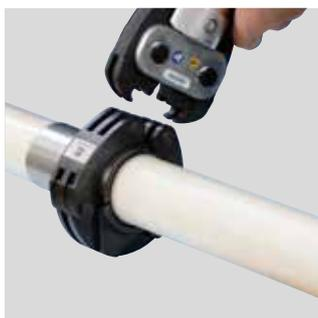
Das kalibrierte und entgratete Verbindrohr bis zum Anschlag in den Fitting einstecken. Dann passende Pressschlinge (gleicher Farbcode wie Fitting) bis zum farbigen Anschlag um die Presshülse legen.
