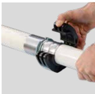
Nach dem Verpressen ist die erfolgreiche Verpressung durch eine deutliche Verformung der Hülse sichtbar (Sichtkontrolle).
