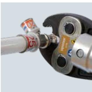
*Die spezielle Form der Presshülsen und der neu konstruierten Anschlagringe sorgt für eine präzise Platzierung der Uponor Pressbacken.*
